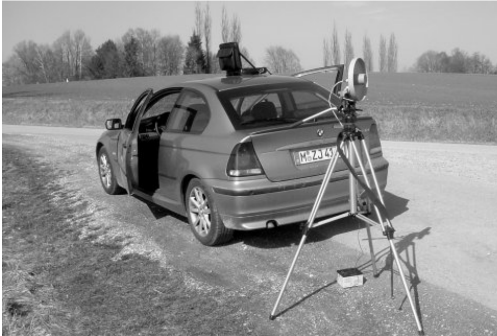
(Bild 13), Messaufbau der Parabolantenne auf einem Stativ mit angeschlossenem Access-Point und einem Gel-Akku als Stromversorgung.
