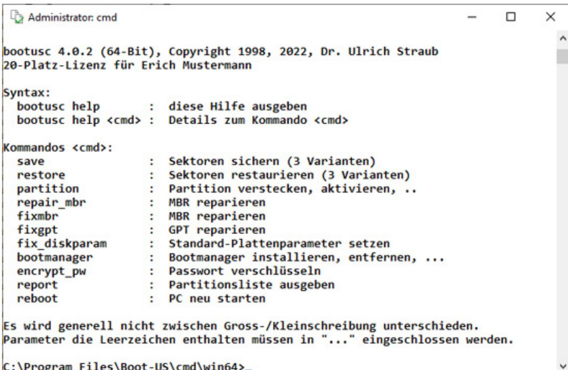
Fig. 3: Konfigurationsprogramm Boot-US (Kommandozeilen-Version)
